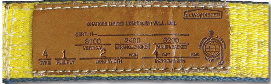
Exemple d'une plaque d'identification de la capacité de l'élingue
